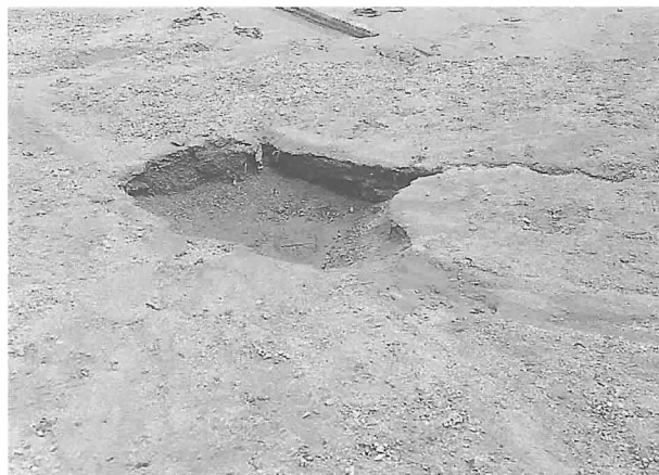
写真 2. 呉高専グラウンドの噴砂孔
