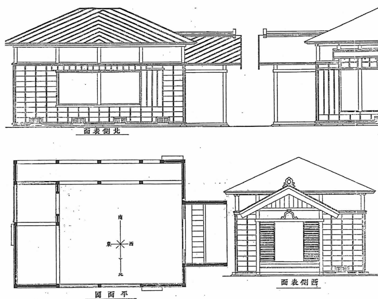
図4 北海道根室に建設せる改良日本風木造家屋建築仕様及図面 5)
