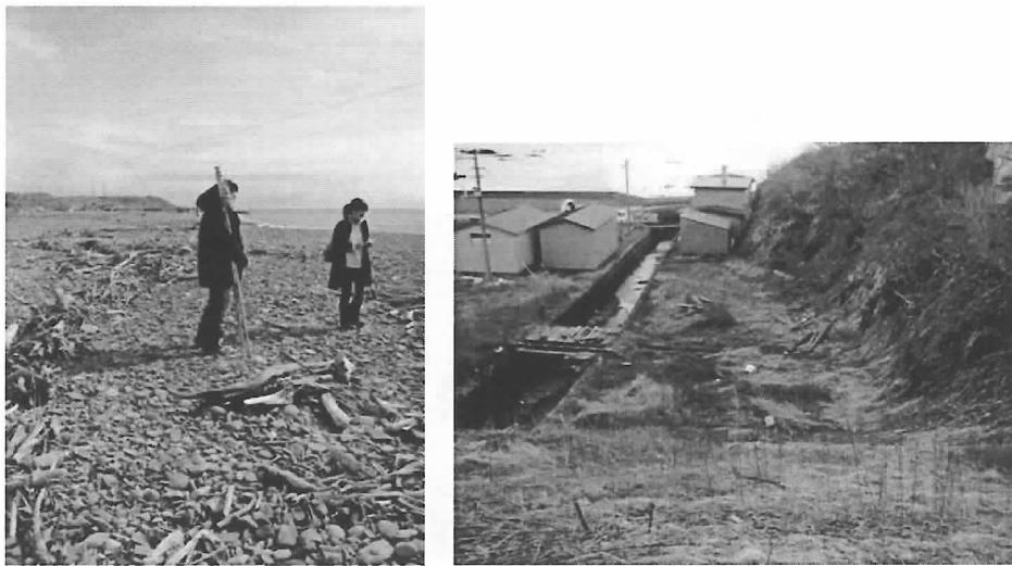
図2 仁雁川河口付近の痕跡堆積物（左：遡上高 3.74m, 遡上距離約 40m), 海抜 4.4m の海岸堤防を乗り越え家屋が浸水。背後の道路法面を遡上した（右：えりも町歌露，痕跡高 4.68m）
