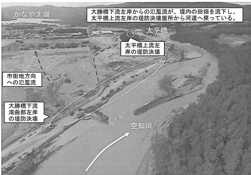
図 8. 3. 2 空知川幾寅地区 堤防決壊及び氾濫状況（上流側から）
