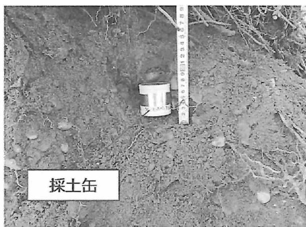
図4.16.4 上流方破堤断面でのサンプリング状況
