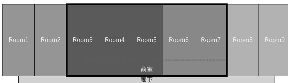
対象 a (黒太線) : Room3~7 で感染発生、Room3~7 は一室化、執務室と前室の間にある壁と扉の上部に欄間有 (赤破線)、AHU は 2 系統 (青、橙)
