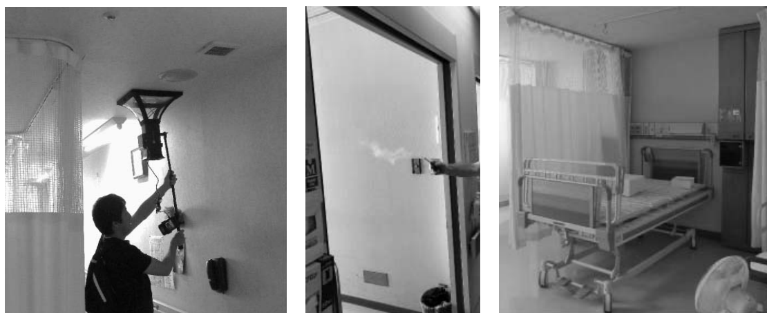
図 4 調査の状況（風量測定 スモークテストによる気流測定 CO 2 による換気測定）
