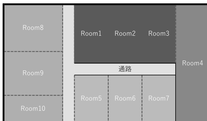
対象 b (黒太線) : Room1~7 で感染発生、Room1~3 は一室化、Room4~10 はそれぞれ個室化、一部の壁の上部に欄間有 (赤破線)、OHU は 1 系統
