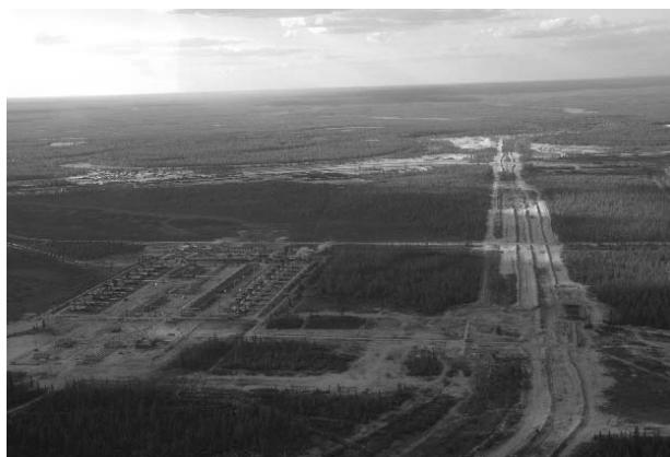
写真-10 西シベリアを駆け抜けるパイプライン：手前から奥行き方向に設けられた半埋設方式の天然ガス・パイプライン（筆者撮影）
